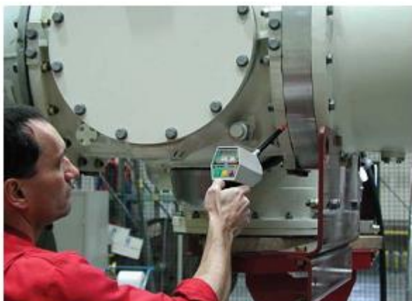
Ilustración 26, Prueba de fuga de hexafluoruro de azufre.
