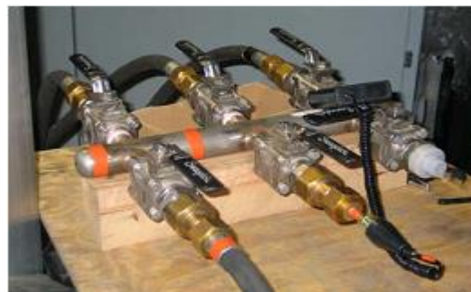
Ilustración 35. Carretilla con bombona de gas para vaciado y llenado de \text{SF}_6 y Manguera manifold típica para realización de vaciado
