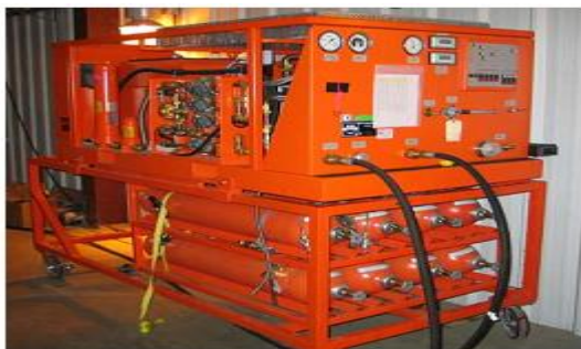
Ilustración 35. Carretilla con bombona de gas para vaciado y llenado de \text{SF}_6 y Manguera manifold típica para realización de vaciado
