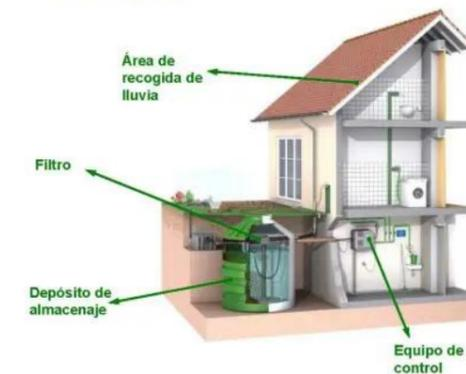
Imagen 19 Componentes de un sistema de aprovechamiento de aguas pluviales. Fuente: Google.
