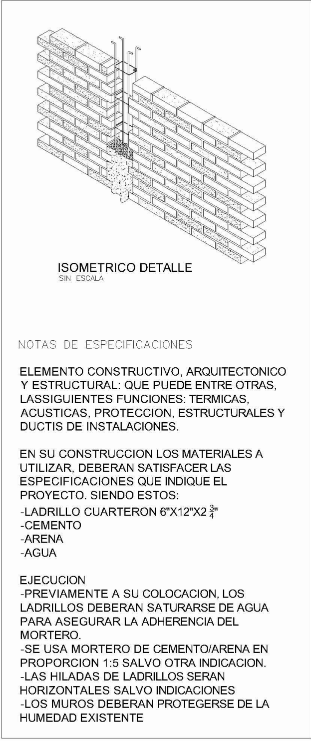
DETALLE DE MURO MAMPOSTERIA
