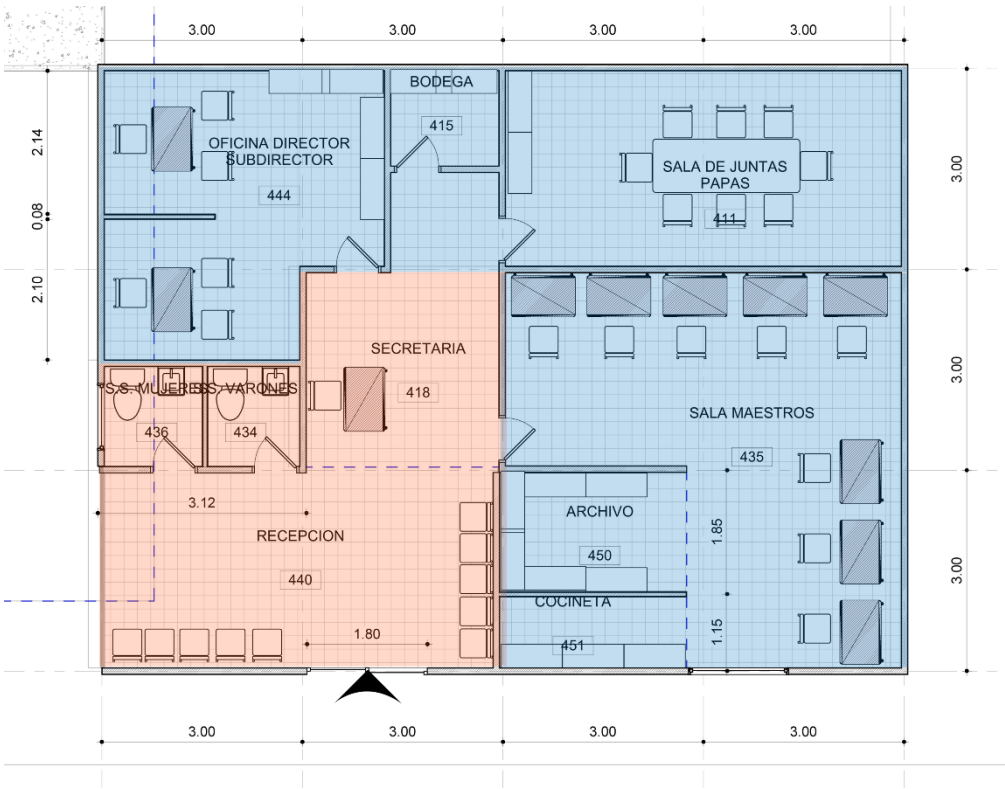
PLANTA ARQUITECTONICA DIRECCION
