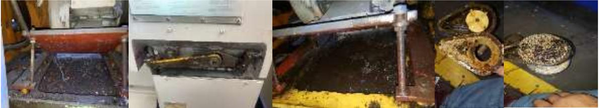
Figura 6: Estado de motor, bomba de refrigeración y el estado de la grasa.
