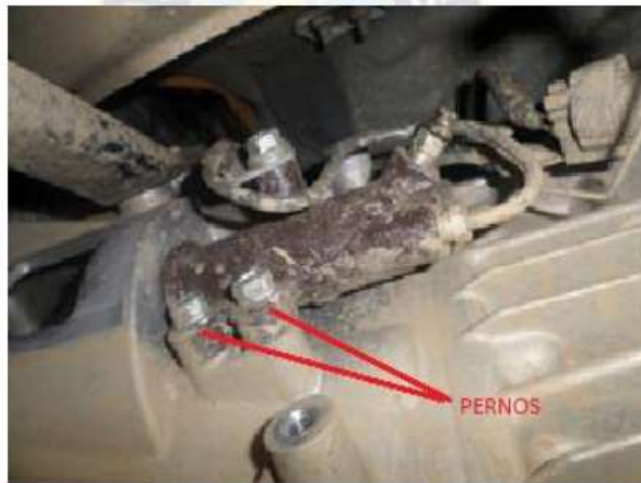
Foto: 12 -Desmontaje del Cilindro Accionamiento
