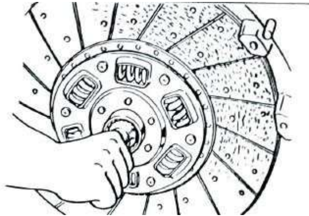
Figura. 18 – Verificación del árbol de alineación.
