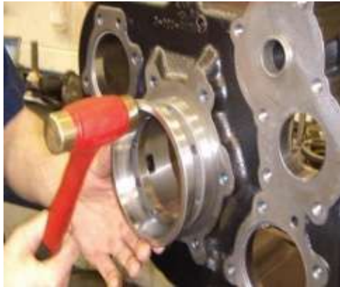
Foto 17- Conjunto del eje principal
