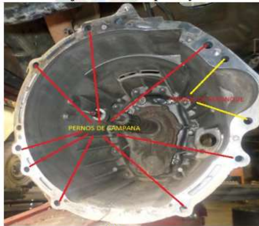
Foto: 11- Desmontaje de la Campana y el Motor Arranque
