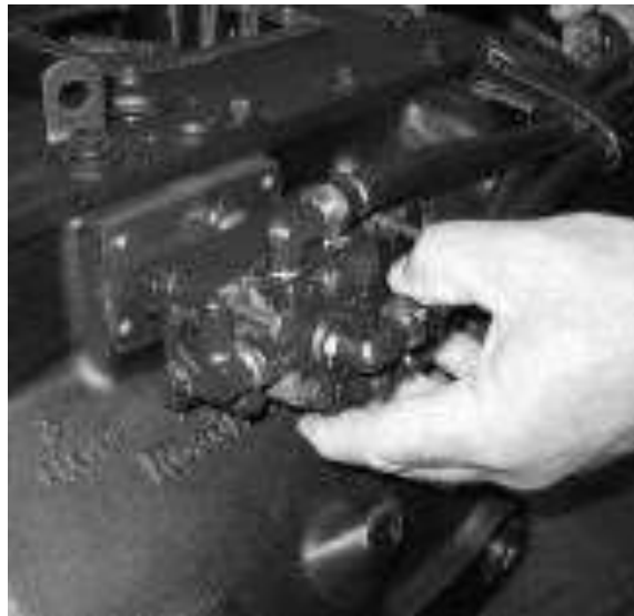
Foto 14 –Extracción de carcas de cambio.
