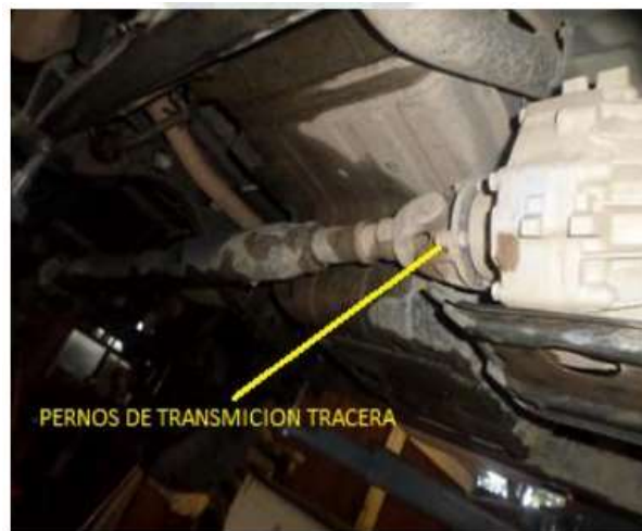
Foto 9- Desmontaje del Árbol de Transmisión Posterior
