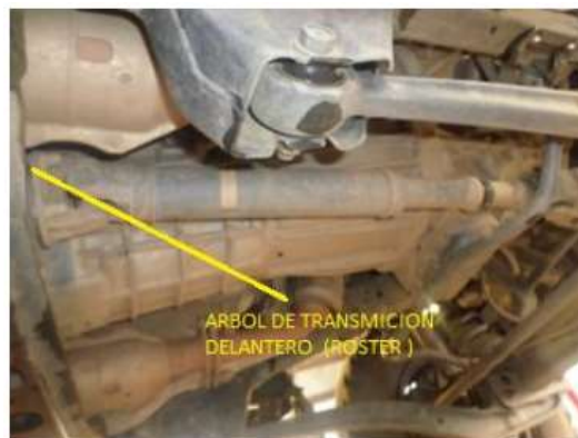
Foto 10- Desmontaje del Árbol de Transmisión Anterior
