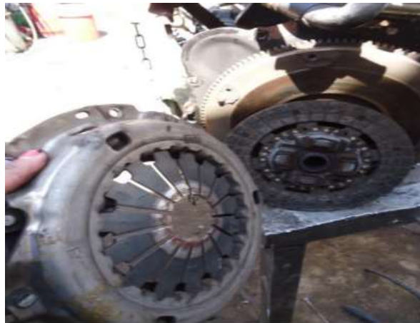
Foto: 1 - Desmontaje del sistema de embrague
