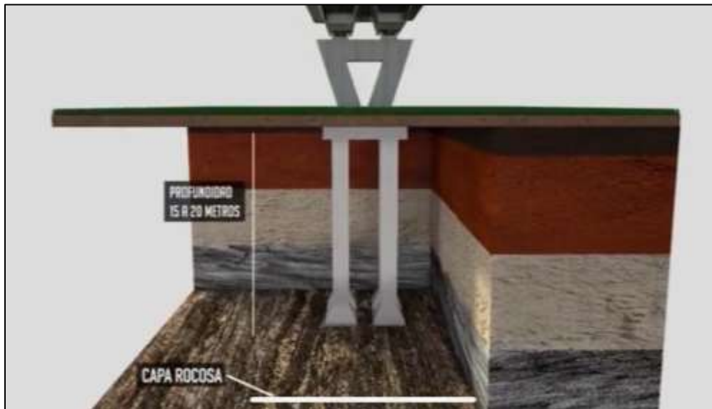
Figura N°8. Cimentaciones a 20 mts de profundidad
