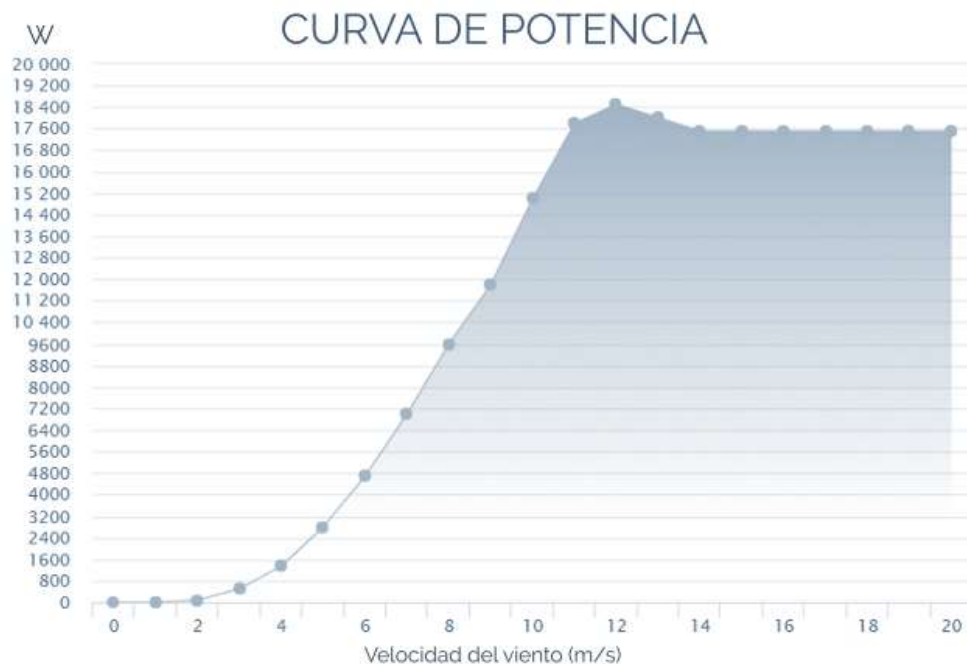
Figura 11 Curva de potencia del aerogenerador
