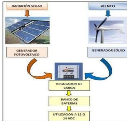
Figura 4 Esquema de un sistema híbrido
