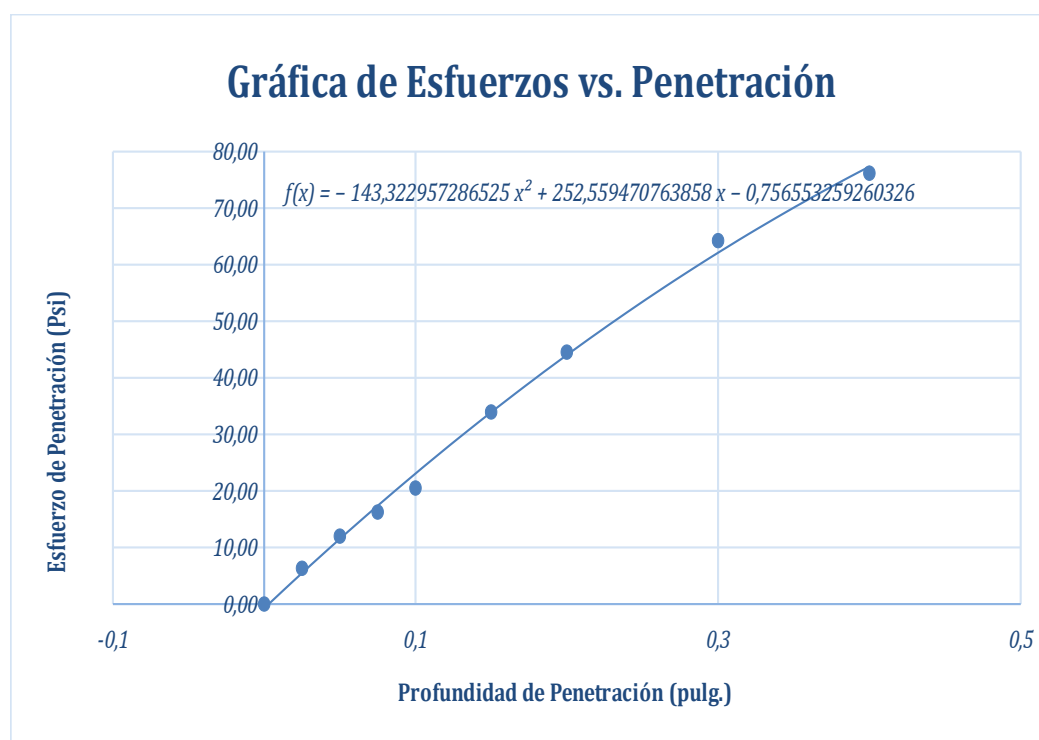
Gráfica 46. Esfuerzo Vs Penetración para el suelo más 10% mixto.
