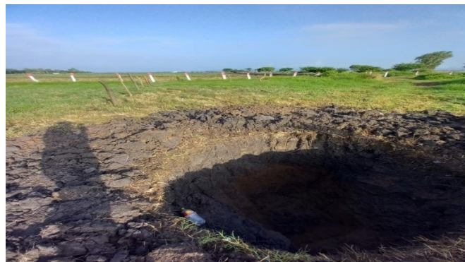
Imagen 2. Calicata N°1. Extracción de muestra en campo.
