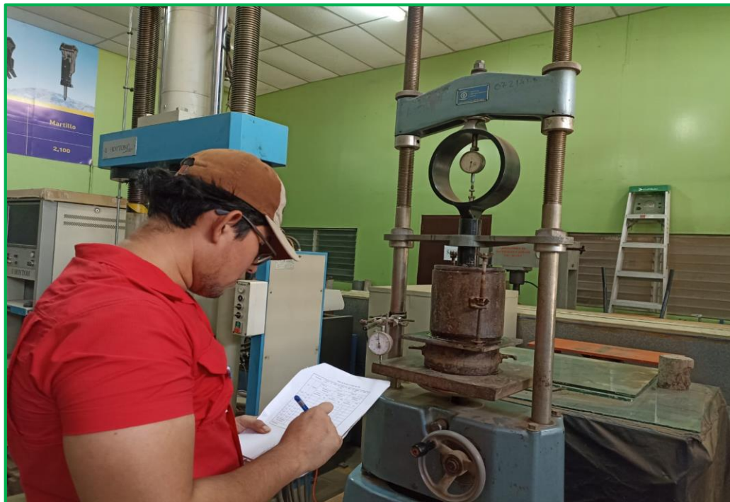
Fotografía 9: Toma de lectura del CBR
