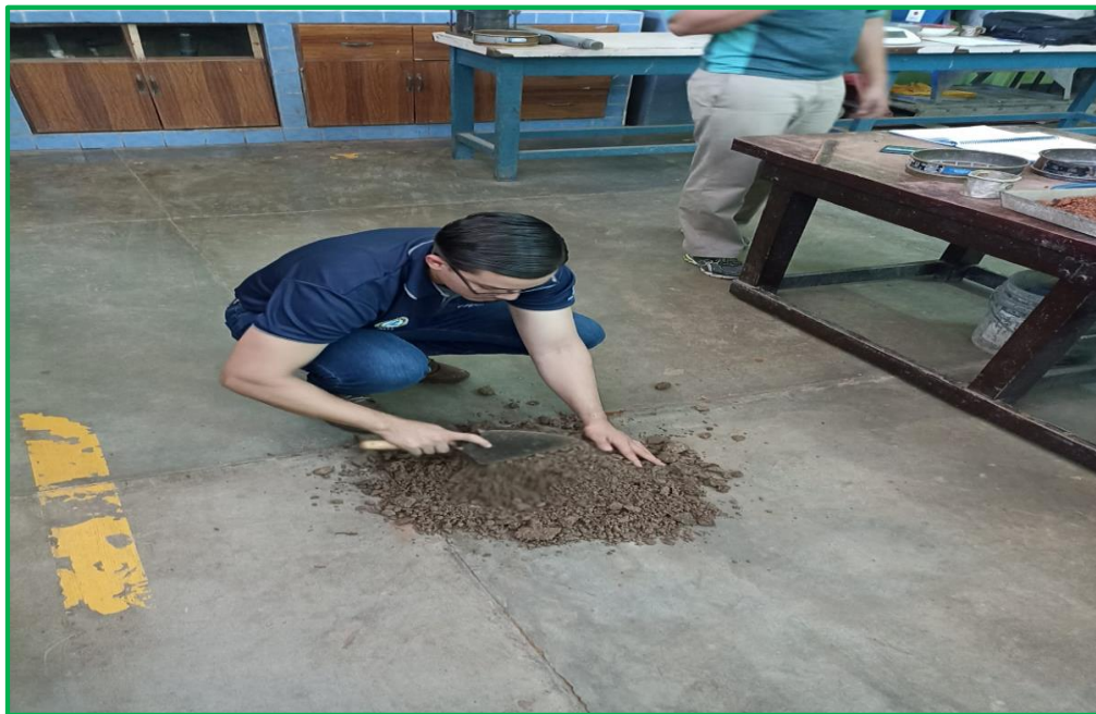
Fotografía 5: Preparación del material de suelo
