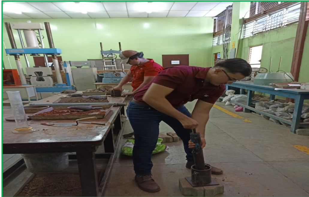
Fotografía 6: Realización de ensayo Proctor
