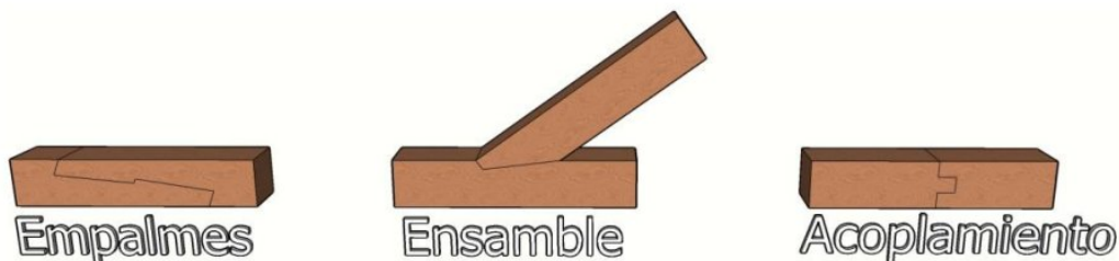
Figura II.8: Tipos de uniones según su forma de encuentro
