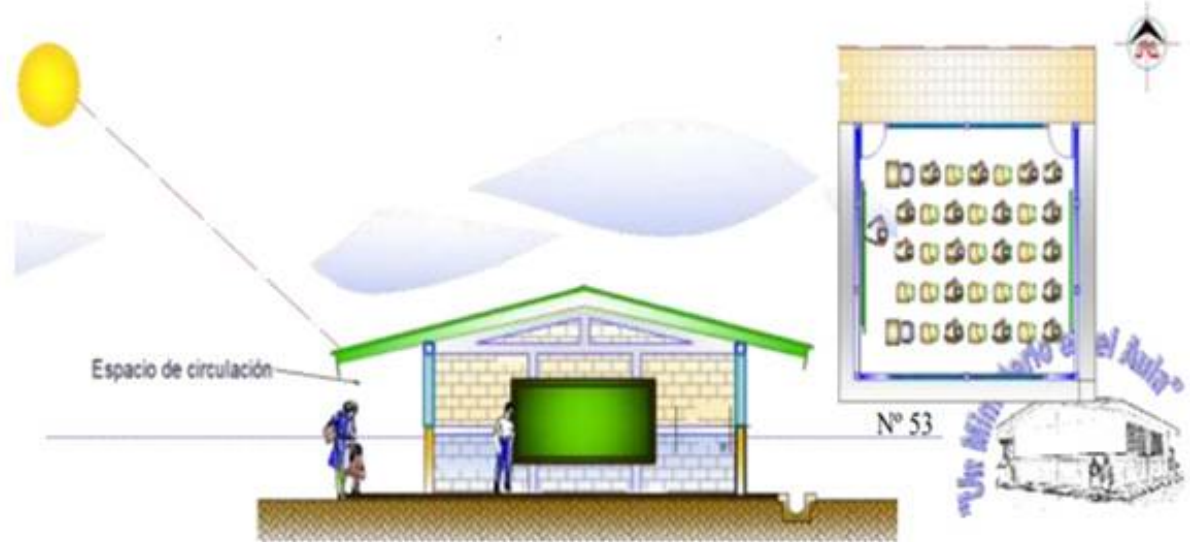
Figura 25 protección solar del aula de clases Fuente: Normas y criterios para establecimientos escolares MINED 2008 p 53
