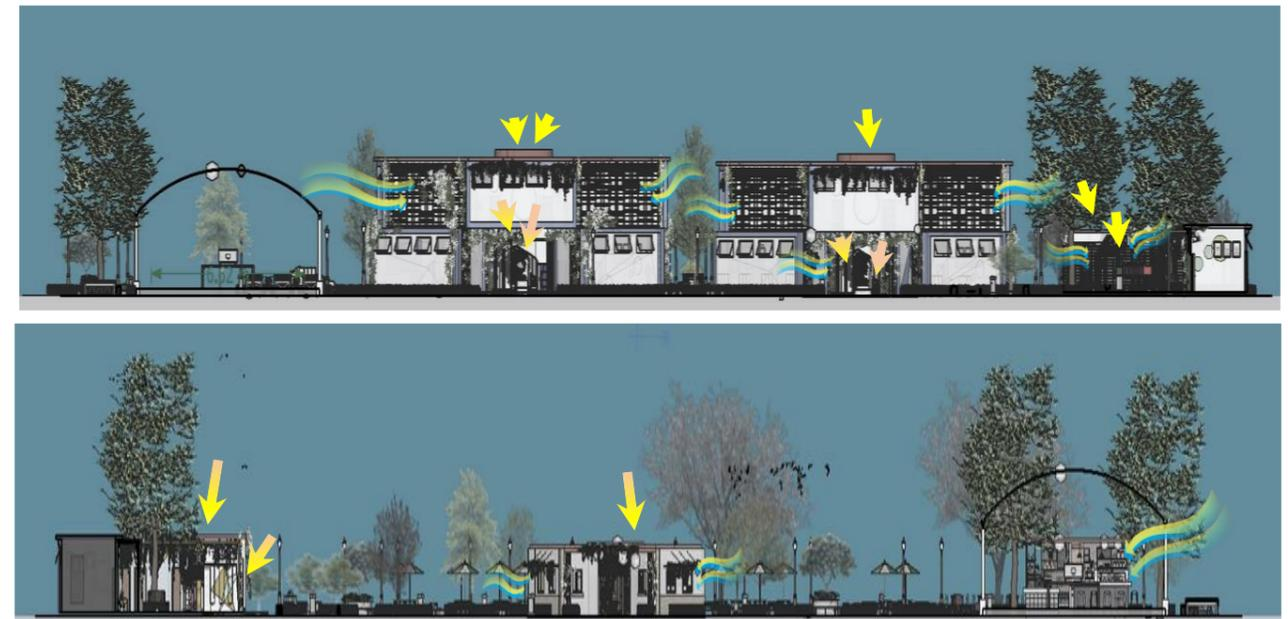
Figura 222: Ejemplo de iluminación y ventilación en cortes de conjunto de análisis - Fuente: Kissu
