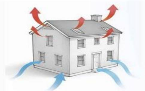
Figura 25: Ejemplo Efecto Chimenea. – Fuente: Arquitectura Pura
