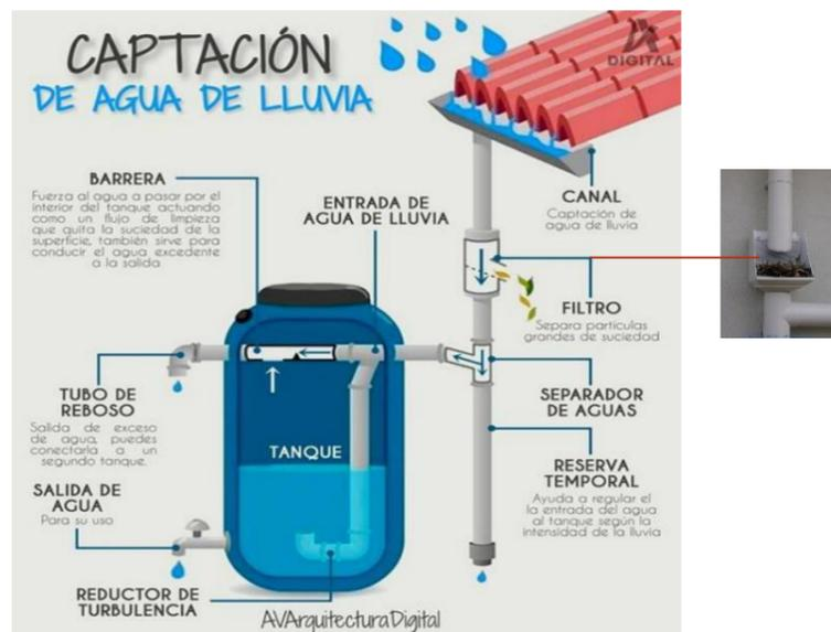
Figura 211: Sistema de Captación de agua pluvial
