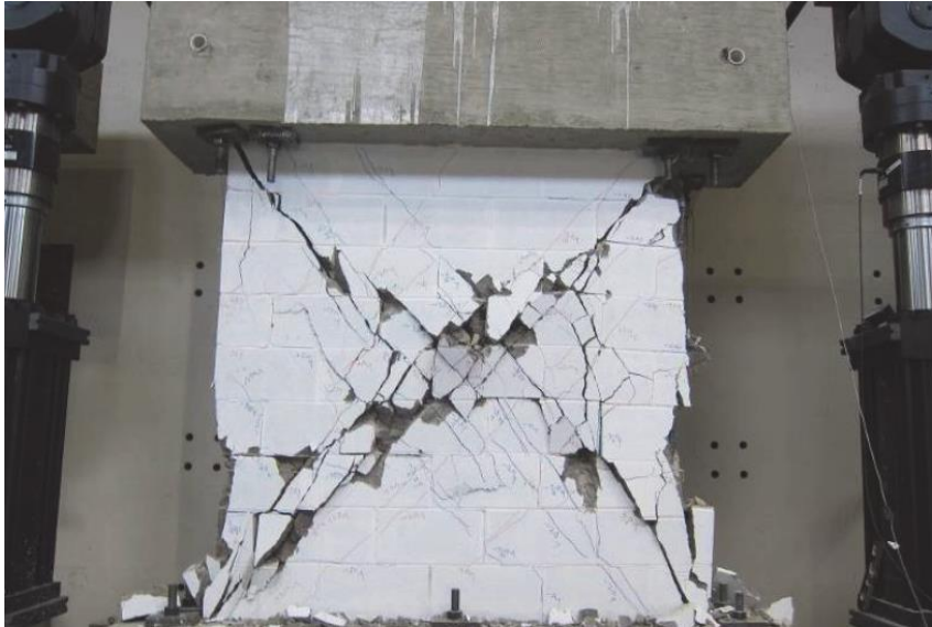
Figura N° 5. Fallas dominadas por corte en el sistema. Ductilidad Limitada. (UT-PBS-02 Ahmadi, 2012.)
