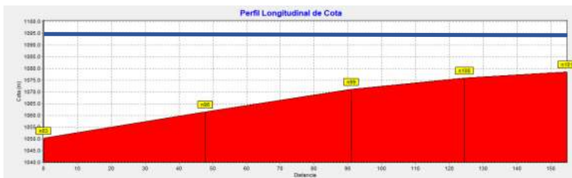
Ilustración 45: Perfil longitudinal de cota
