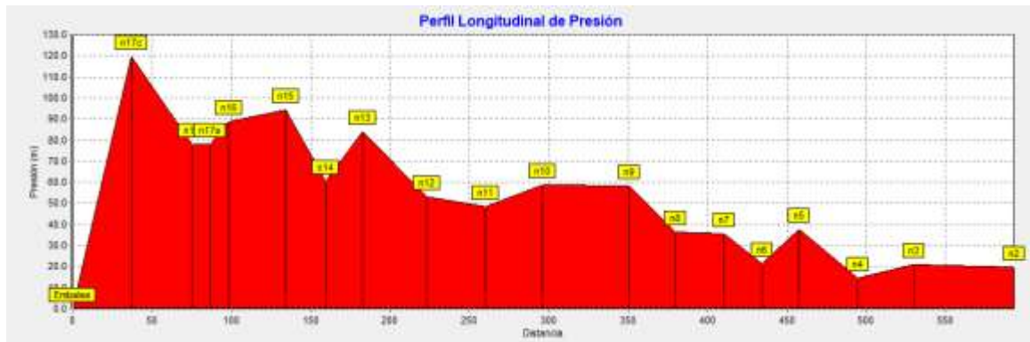
Ilustración 20: Perfil longitudinal de presión
