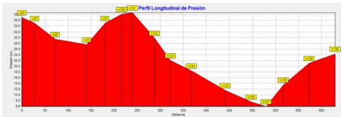
Ilustración 26: Perfil longitudinal de presión
