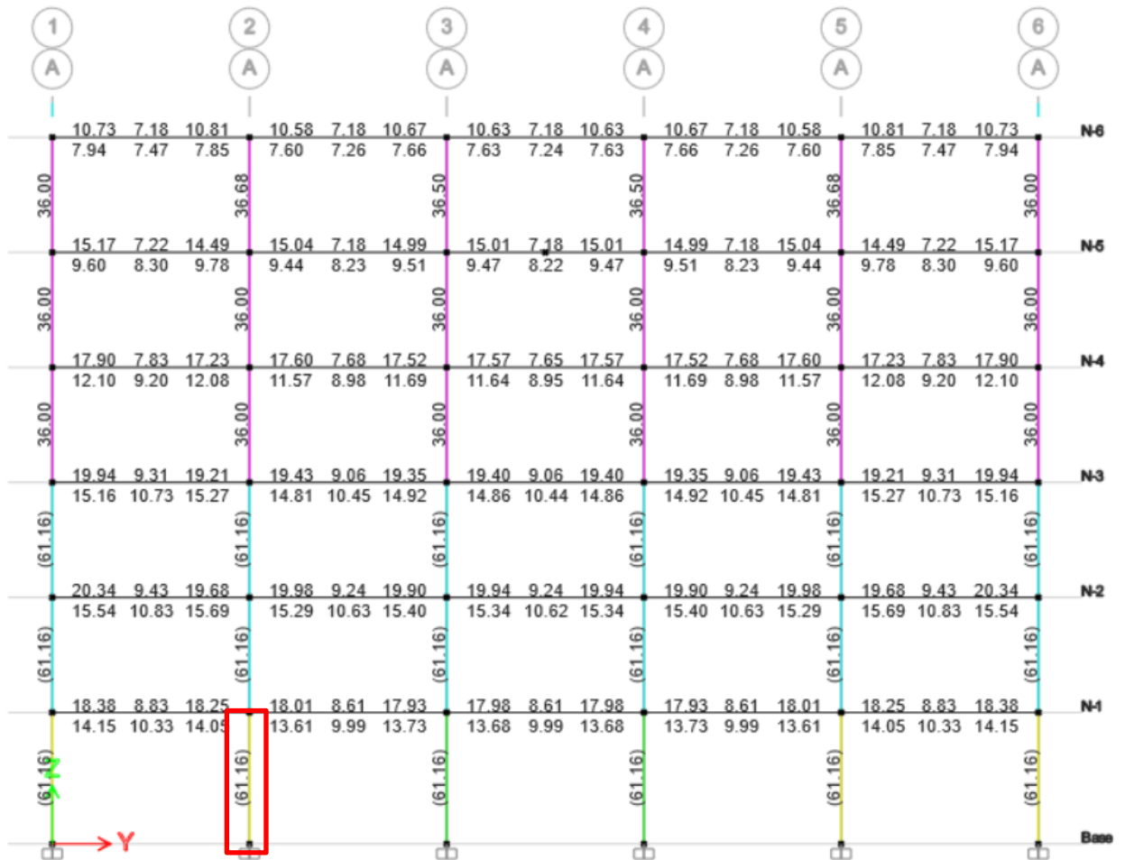
Figura 3-38 Elevación Estructural del Diseño de Columna CS-1
