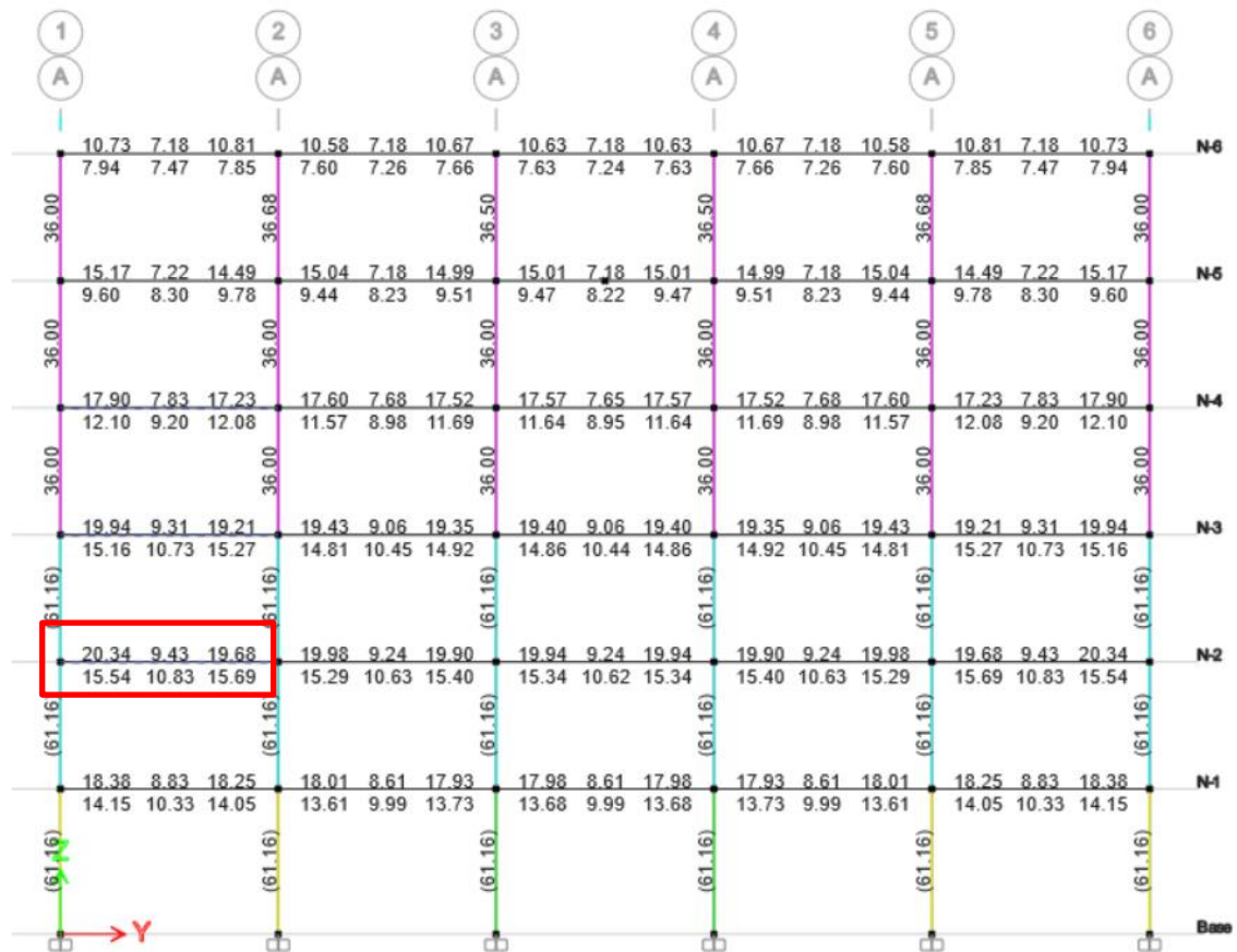
Figura 3-31 Elevación Estructural del Diseño de Viga VS-1
