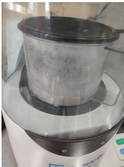
Figura 13. Trituración de partículas mayores a la deseada por medio de molino de cuchillas marca Retsch para el aprovechamiento de mayor cantidad de harina obtenida. Fuente: Elaboración propia.
