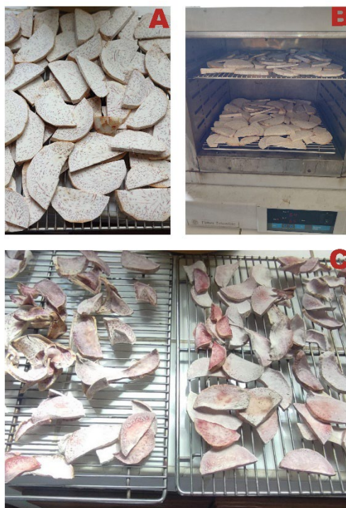
Figura 10. Distribución y posicionamiento de bandejas con malangas. A) Distribución de malangas en bandeja rejilla. B) Colocación de bandejas rejillas en el horno. C) Malanga tras finalizar el proceso de secado. Fuente: Elaboración propia.
