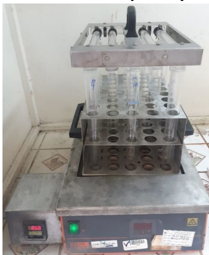
Figura 15. Recolección de humo de ácidos en un digestor marca Foss. Fuente: Elaboración propia.
