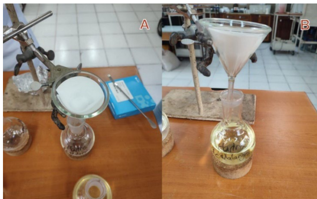
Figura 20. Filtración de disolvente orgánico y el extracto etéreo de la harina de malanga. A) Preparación del medio filtrante con papel filtro y sulfato de sodio anhidro. B) Muestra de hexano y harina de malanga ya filtrada. Fuente: Elaboración propia.
