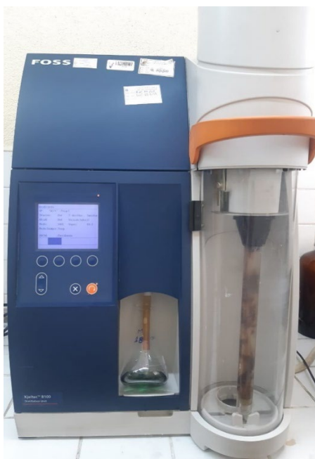
Figura 16. Proceso de destilación de la harina de malanga mediante destilador Foss. Fuente: Elaboración propia.
