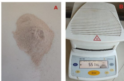
Figura 14. Proceso de análisis de humedad en harina de malanga. A) Muestra a analizar. B) Analizador de humedad Sartorius. Fuente: Elaboración propia.
