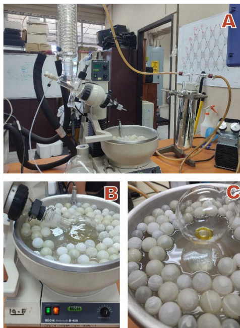
Figura 21. Proceso de extracción del hexano del extracto etéreo de la harina de malanga. A) Instalación de equipo rotavapor Büchi R-124, baño Büchi B-480, colector de disolvente orgánico y la bomba de vacío. B) Posicionamiento adecuado del rotavapor Büchi con el balón en el baño Büchi. C) El extracto etéreo resultante del proceso de destilación a presión baja. Fuente: Elaboración propia
