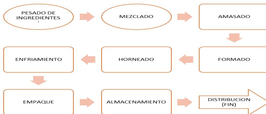
Figura 14. Diagrama de bloque del proceso de elaboración de galletas.
