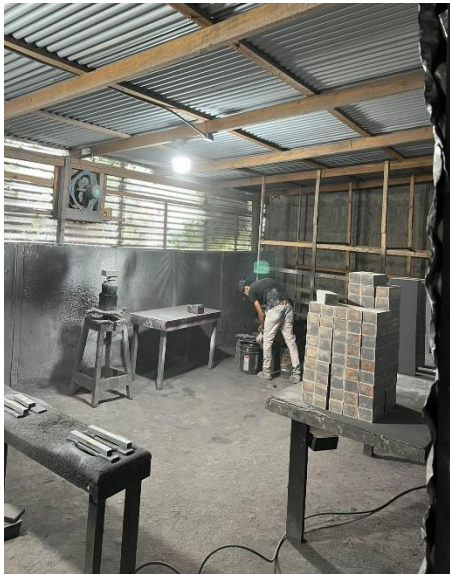
Ilustración 15. Ventilación en el área de pintura de la Carpintería
