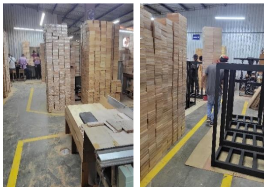
Figura 6. Riesgo de caída de objetos en pasillos
