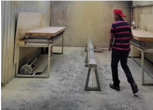
Figura 10. Trabajador de sellado sin equipo de protección personal
