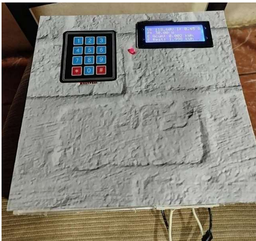
Figura No. 14 – Diseño final de Medidor de Energía Prepago.
