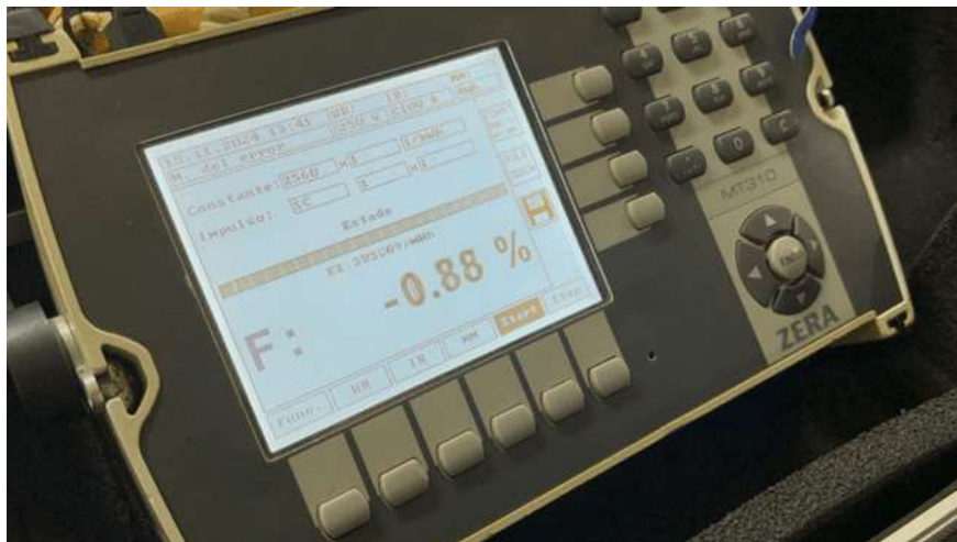
Figura No. 18 – Resultado del Ensayo #3 realizado por el Patrón ZERA.
