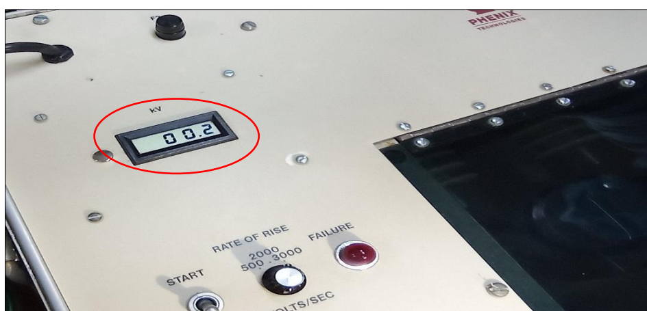
Figura 21: Error de lectura al momento de encender el equipo de prueba
