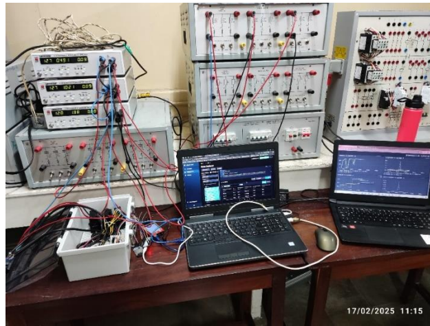
Fig. 53: Pruebas de laboratorio utilización el sistema de medición con el método de los tres vatímetros con tres PROGRAMMABLE POWER METERS HM8115-2. (Fuente Propia)
