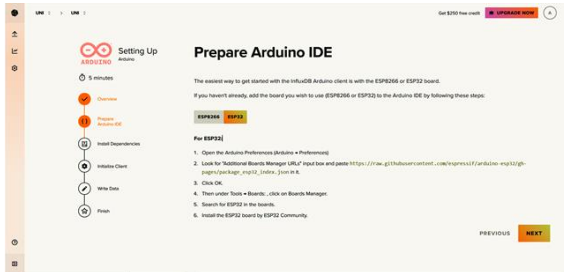
Fig. 32: paso iniciales Arduino IDE y ESP32 (InfluxData, Inc., 2025)
