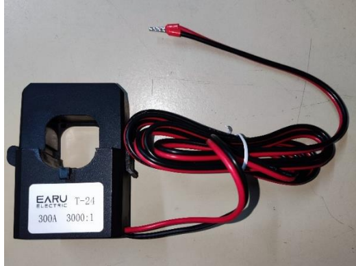
Fig. 16: Ilustración del transformador de corriente de núcleo partido de 300 A (Fuente Propia)
