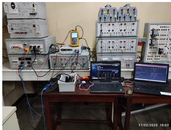
Fig. 54: Pruebas de laboratorio con un analizador de redes monofásico. (Fuente Propia)
