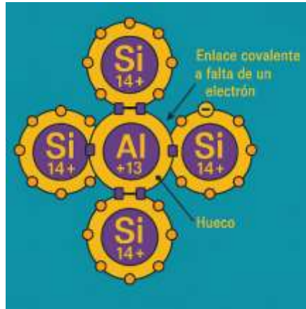
Figura No.6 , Estructura Cristalina del Si con un átomo de impureza Al. (Carta González, J. A et al. (2009).
