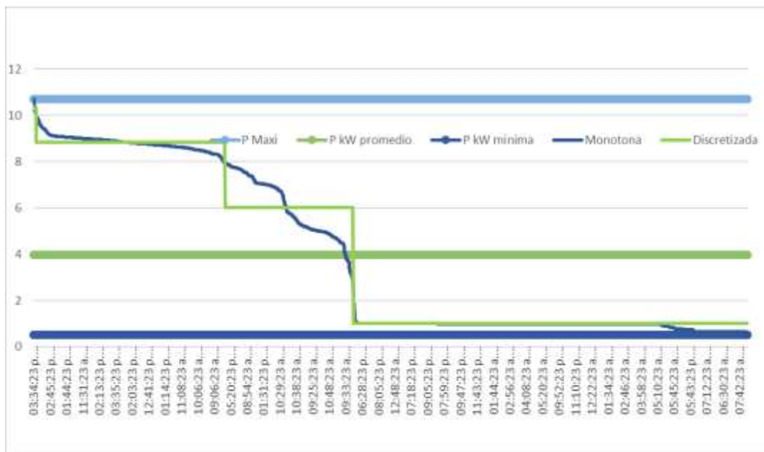
Figura No.39, Curva Monótona de Perfil de Carga de Almacén - APC
