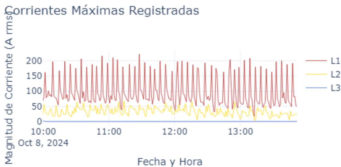
Figura 61: Gráficos de corriente del Panel BT04.2 del Banco de Transformador BT04 generado con Python-Plotly
