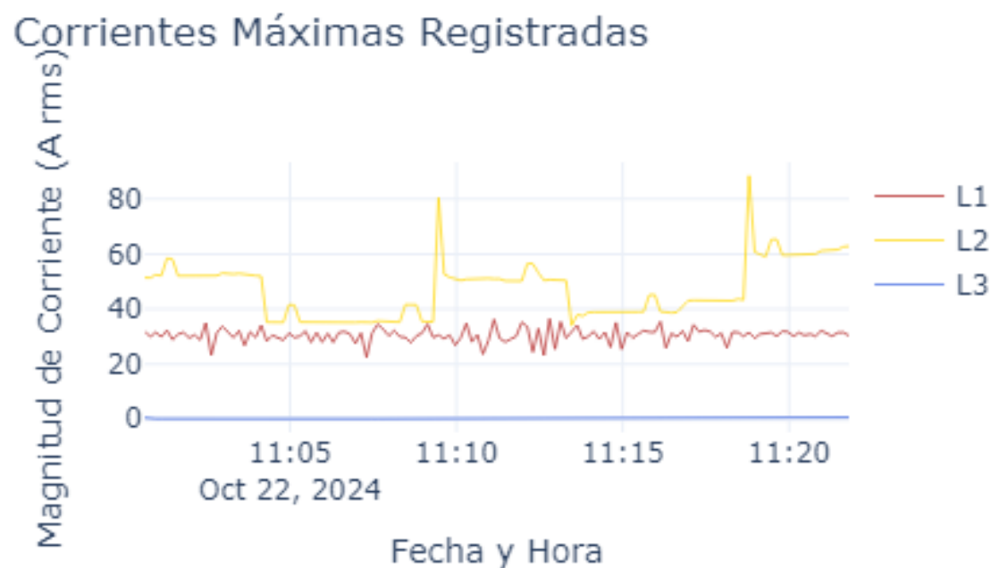
Figura 62: Gráficos de corriente del Panel BT05.6 del Banco de Transformador BT05 generado con Python-Plotly
