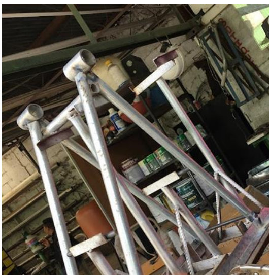
Anexo 16: Elaboración de bomba de mecate
