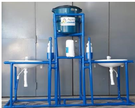
Anexo 15: Lava mano doble a base de tubos PVC terminado
