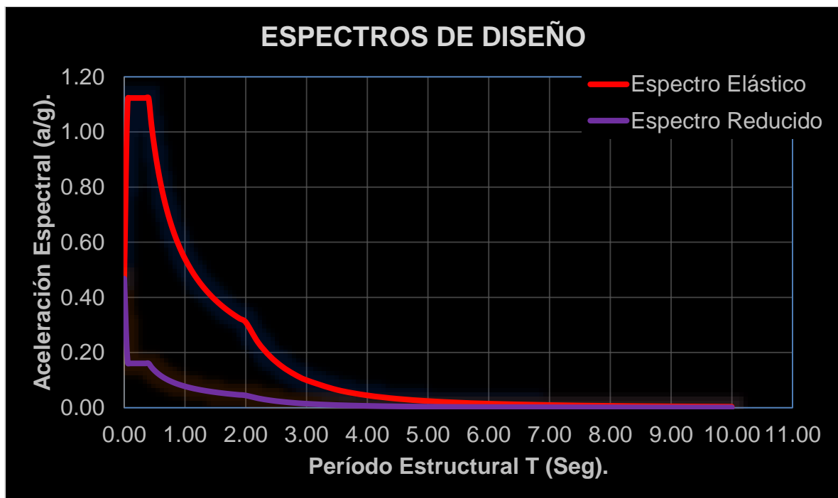
Figura XI. Espectro elástico e inelástico. Fuente: Elaboración propia en Excel.
