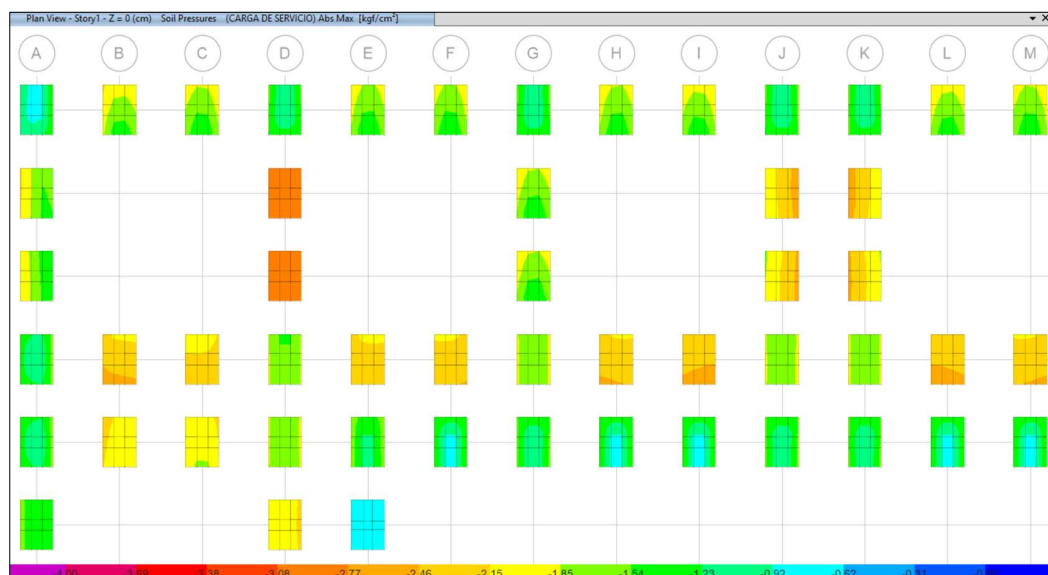
Figura 51: Análisis de capacidad admisible del suelo
