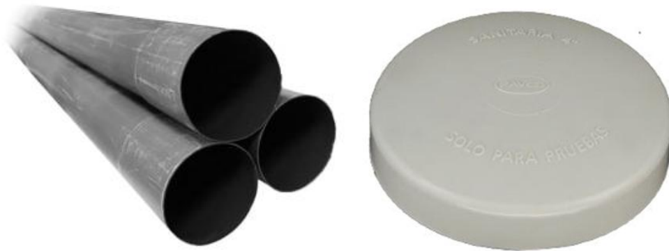
Figura 12. Tubo pvc de 4" y tapón de pvc para simular el molde adecuado para los cilindros de la mezcla.
