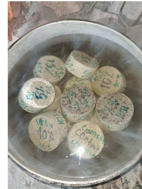
Figura 18. Ensayos sumergidos en agua caliente
