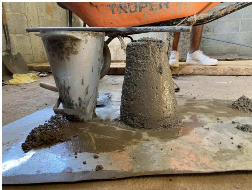
Figura 14. Prueba de Revenimiento
