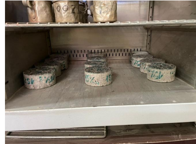
Figura 21. Ensayos secados al horno por 24 horas
