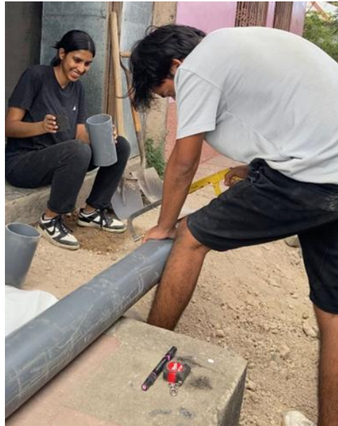
Figura 11. Creación de los 24 moldes para los especímenes de concreto
