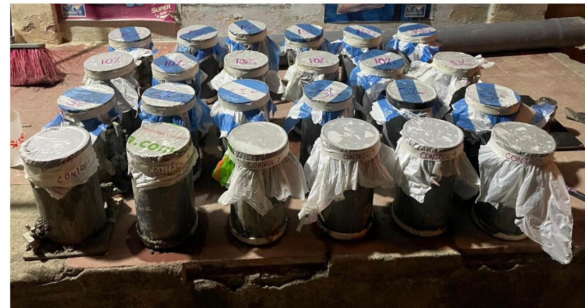
Figura 13. Especímenes finalizados respectivamente sellados y etiquetados para su desmolde al día siguiente
