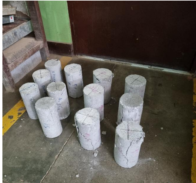
Figura 16. Cilindros reventados post-prueba de compresión
