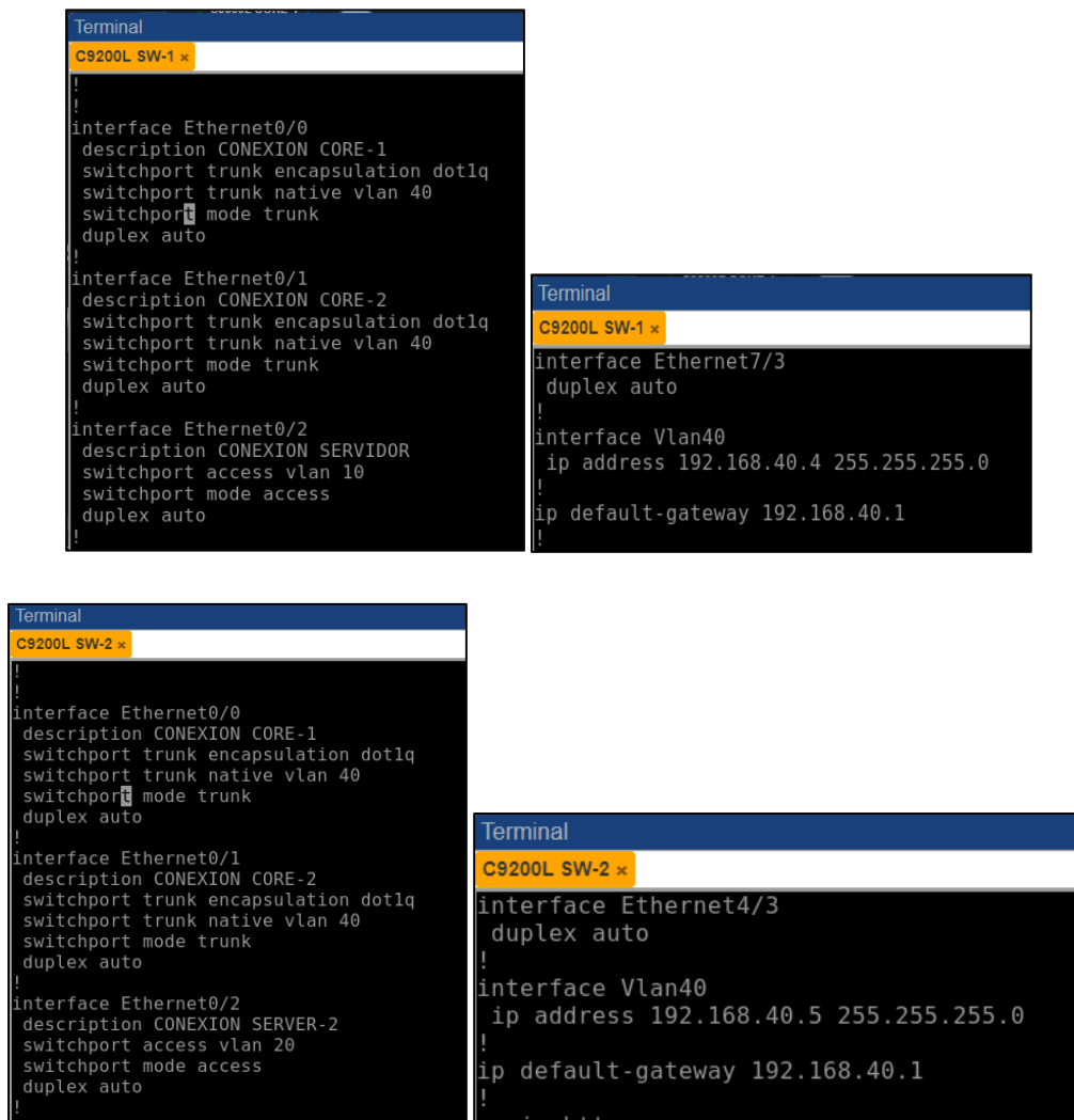
Imagen No.48: Configuración de interfaces e IP de gestión en equipo de acceso C9200L-1 y C9200L-2. Esta configuración se repite en los demás equipos de acceso.
