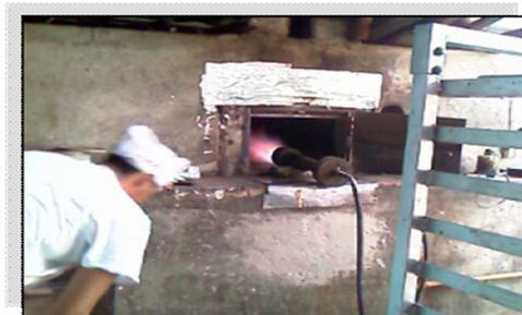
Imagen 4: Precalentado del horno de barro.
