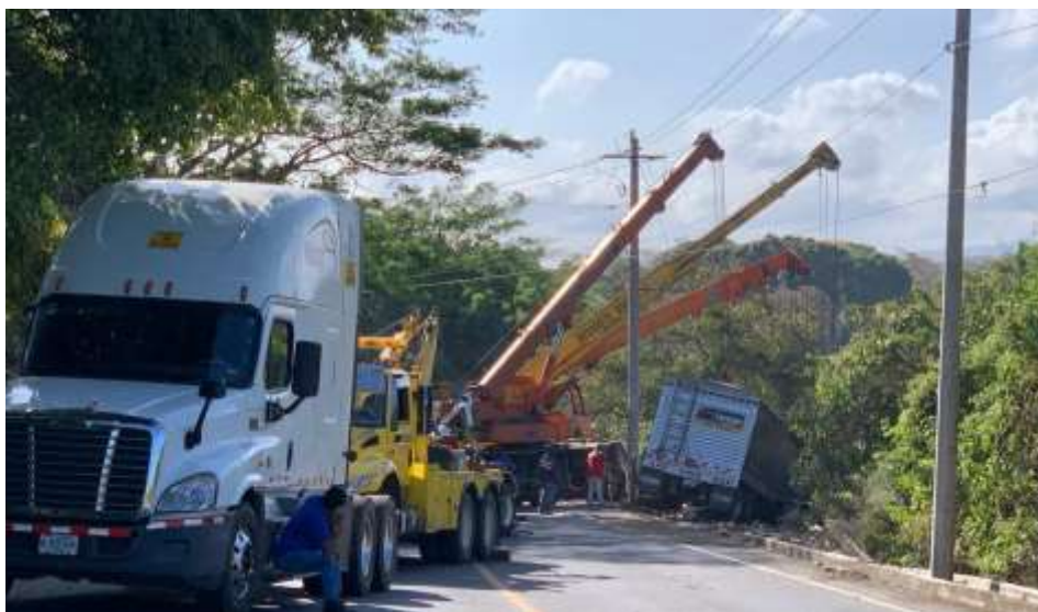
Figura 10 Extracción del vehículo pesado accidentado en el km 15 mediante doble grúa
