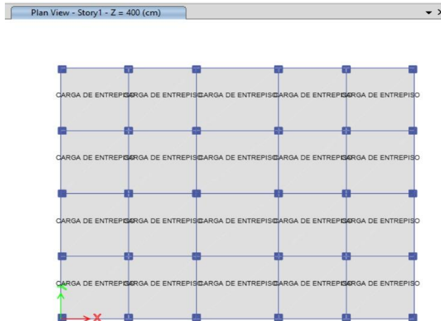
Figura 19 - Carga de entrepiso asignada a la losa
