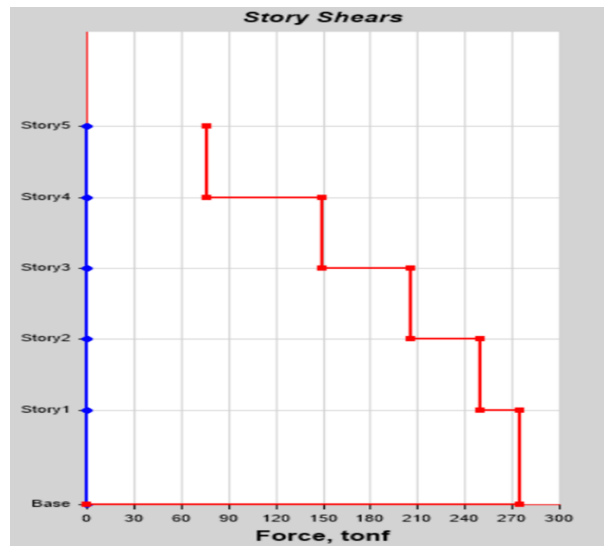
Figura 41- Cortante de piso en eje X
