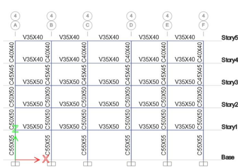
Figura 7– Distribución por nivel de vigas y columnas
