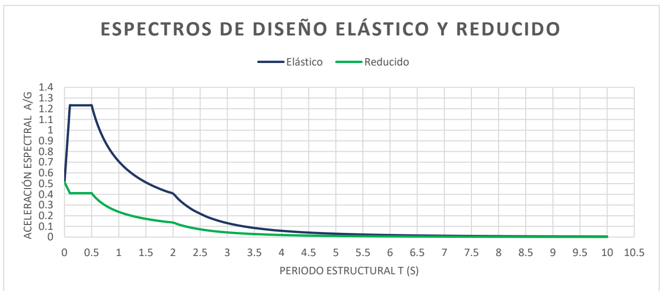
Figura 3.10: Resultados de espectros de diseño elástico y reducido para Mampostería Reforzada
