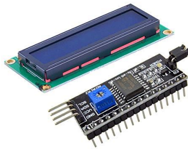
Figura 27. Módulo adaptador LCD a I2C [23].
