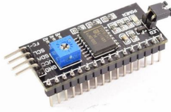
Figura 25. Módulo adaptador LCD a I2C [23].
