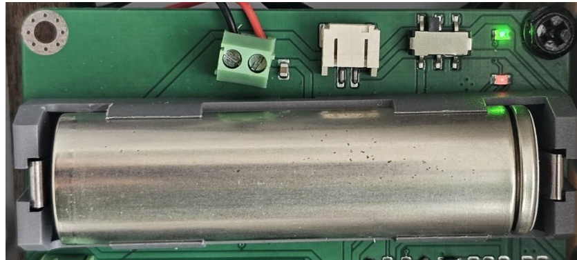
Figura No. 26 Batería 18650 junto al LED de carga
