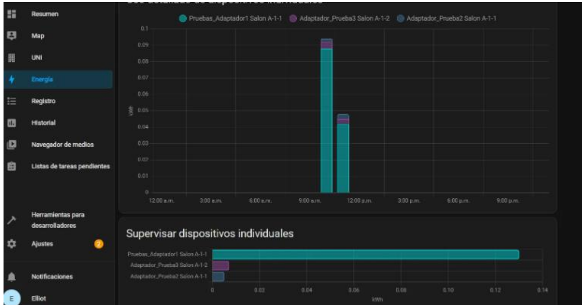
Figura No. 37 Monitoreo de consumo energético del salón de profesores de telecomunicaciones
