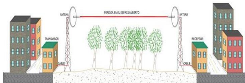
Figura No 10. Representación de un radio enlace punto a punto
