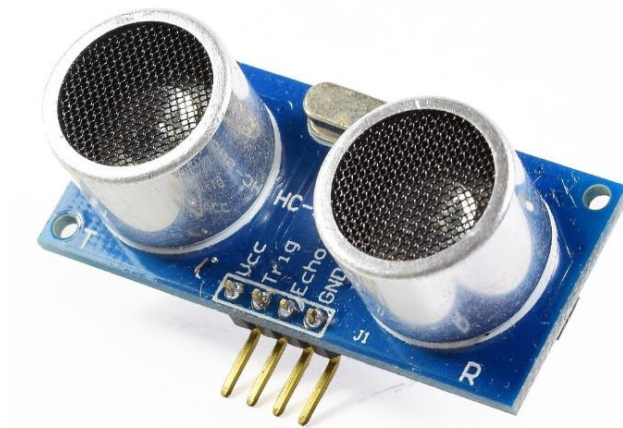
Figura 20: Sensor ultrasónico HC-SR04
