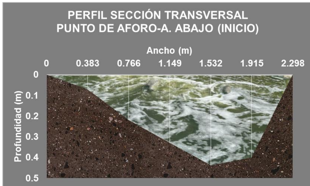
Figura 31. Perfil de sección transversal 1 del cuerpo receptor (aguas abajo)
