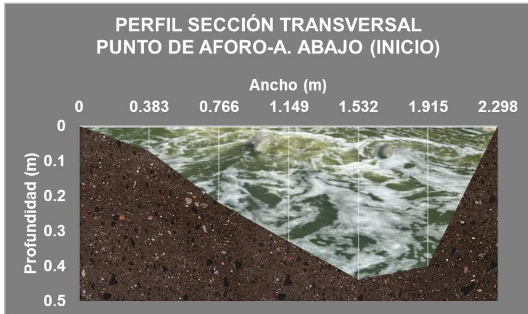
Figura 9. Perfil de sección transversal representativa aguas abajo
