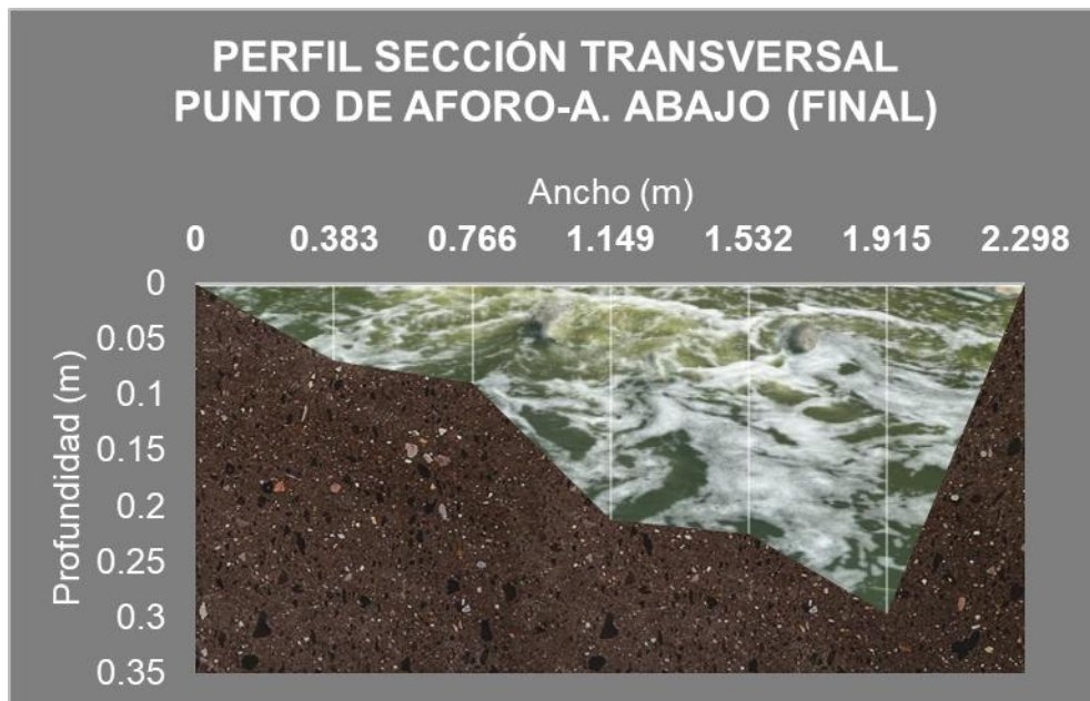
Figura 33. Perfil de sección transversal 3 del cuerpo receptor (aguas abajo)
