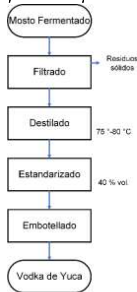
Figura 14. Diagrama de bloques para la etapa de destilado
