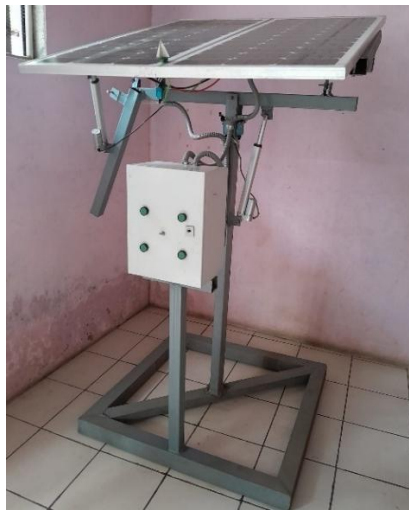
Estructura de Soporte Ensamblada
