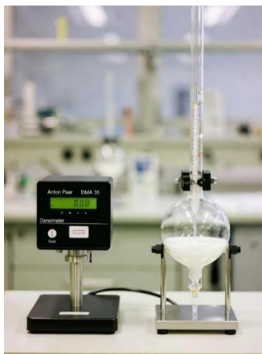
Figura 22: Equipo y procedimiento para medición de densidad de leche con lactodensímetro
