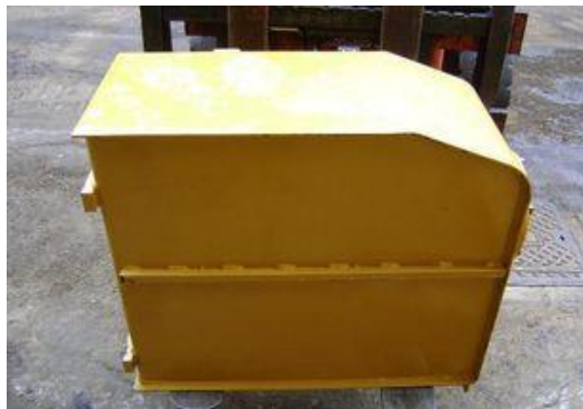
Figura n°7: Tanque de Combustible
