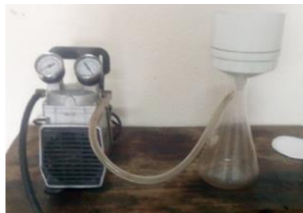
Figura 9: Sistema de filtración al vacío.
