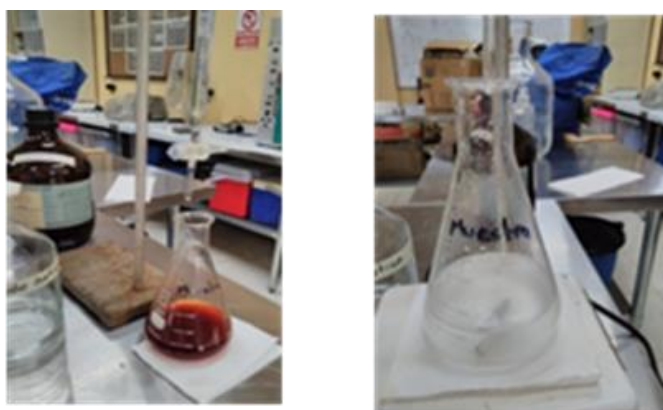
Figura 15: Titulación de la muestra para el índice de yodo.
