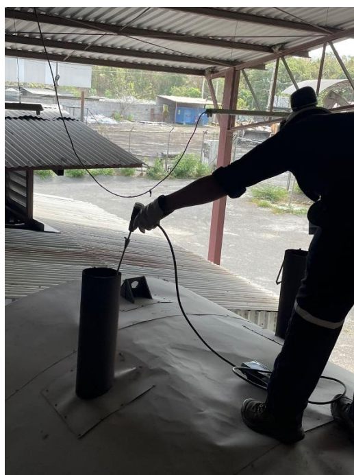
Figura No. 5.1. Medición de composición de gases de combustión.
