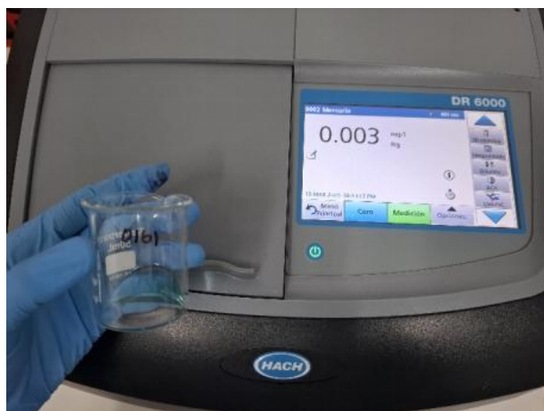
Ilustración 17: Lectura de cantidad de Mg presente en muestra de agua en manantial
