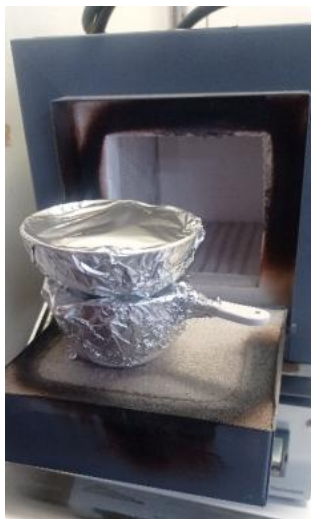
Ilustración 12: Crisoles con cargas de Moringa para su carbonización
