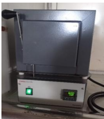
Ilustración 13: Carbonización del material vegetal a 600°C
