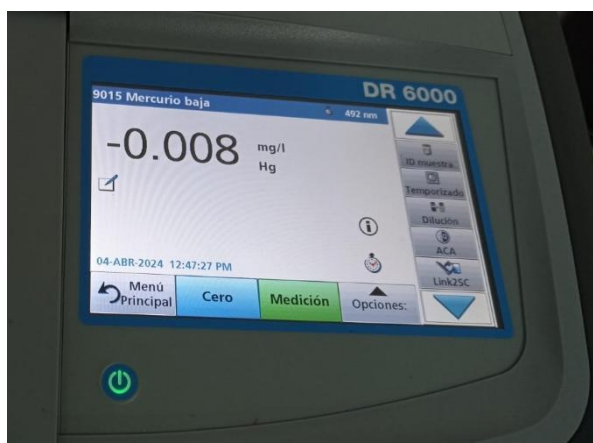
Ilustración 18: Lectura del espectrofotómetro DR6000 que muestra la concentración de mercurio tras el proceso de bioadsorción.
