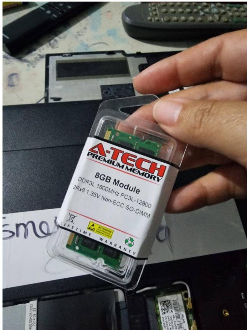
Ilustración Anexo C. 11: Reemplazo de Memoria RAM
