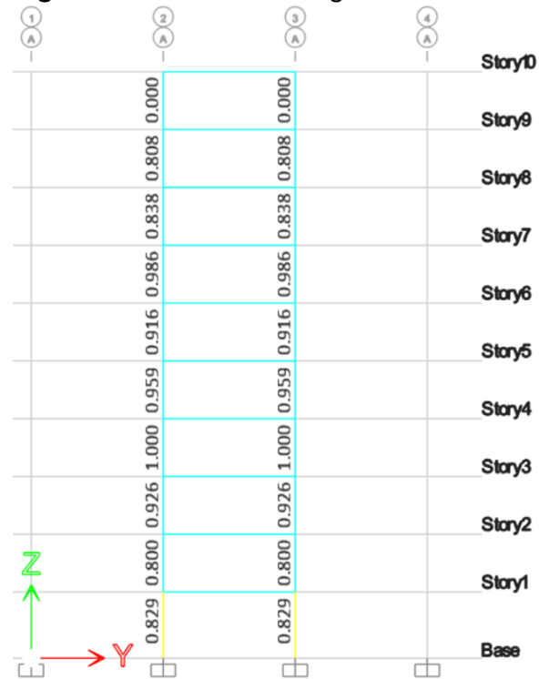
Figura 4-15. Relación Viga / Columna en Eje A.
