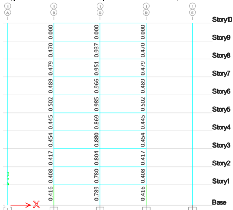
Figura 6-5. Relación Viga / Columna en Eje 1.
