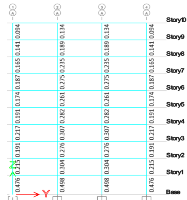
Figura 6-4. Relación D/C en columnas de Eje A.
