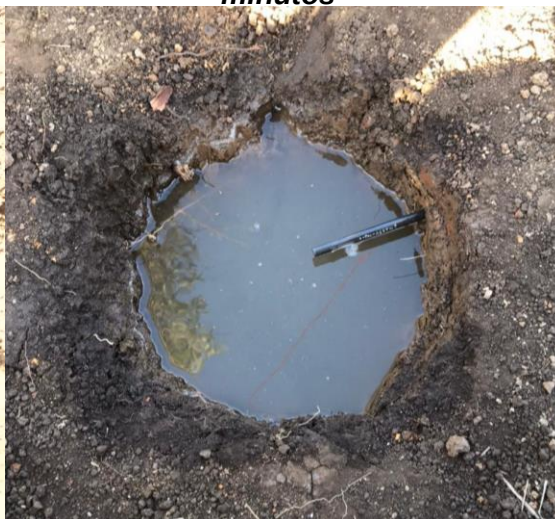
Ilustración 37 "Medición de cuánta agua se infiltró en el lapso de 10 minutos"
