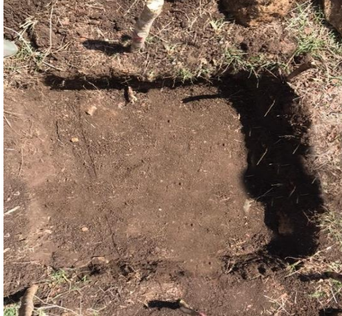
Ilustración 33 " Limpieza del lugar 1m2 y profundidad de 30 cm donde se aplicara el metodo porchet"
