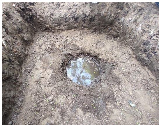
Ilustración 32 "Llenado de agua en la perforación para saturar el suelo"
