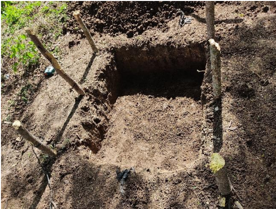
Ilustración 25 "Limpieza del lugar 1m2 y profundidad de 30 cm donde se aplicará el método de porchet"
