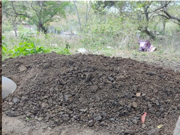
Ilustración 25 "Limpieza del lugar 1m2 y profundidad de 30 cm donde se aplicará el método de porchet"
