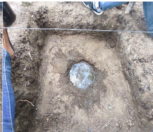
Ilustración 31 "Medición de cuánta agua se infiltro en el lapso de 10 minutos"
