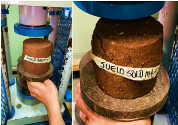
Figura 15 Probeta de suelo natural sometida a resistencia a la compresión
