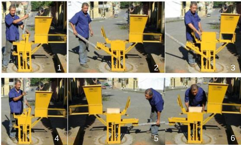
Figura 4 Prensado del BTC
