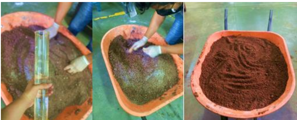
Figura 26 Mezcla húmeda para fabricar BTC.
