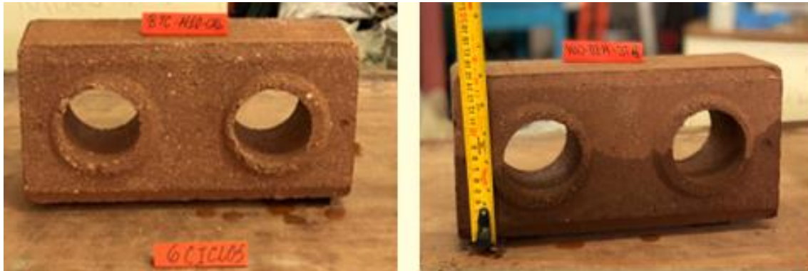
BTC de suelo + 15% Cal Hidratada
