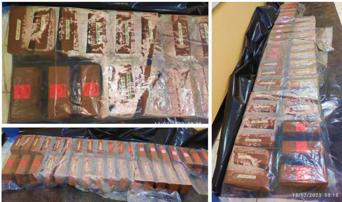
Figura 30 Curado y secado de los BTC
