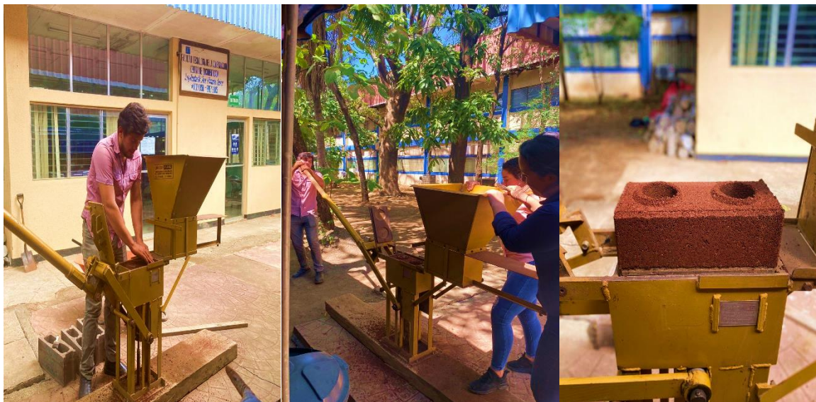
Figura 29 Prensado de los BTC.
