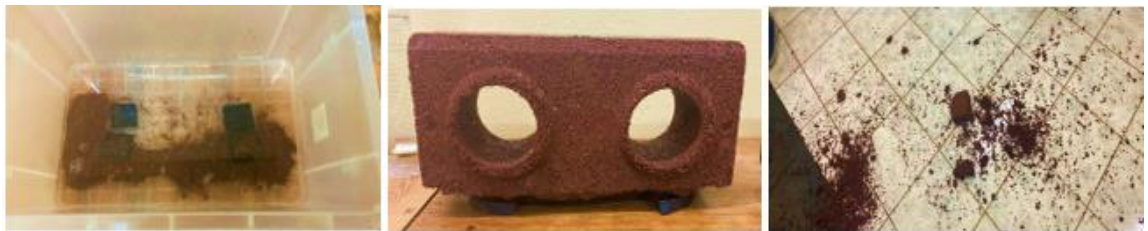
Figura 44 Primer ciclo de Humedad/Secado de BTC de suelo natural.
