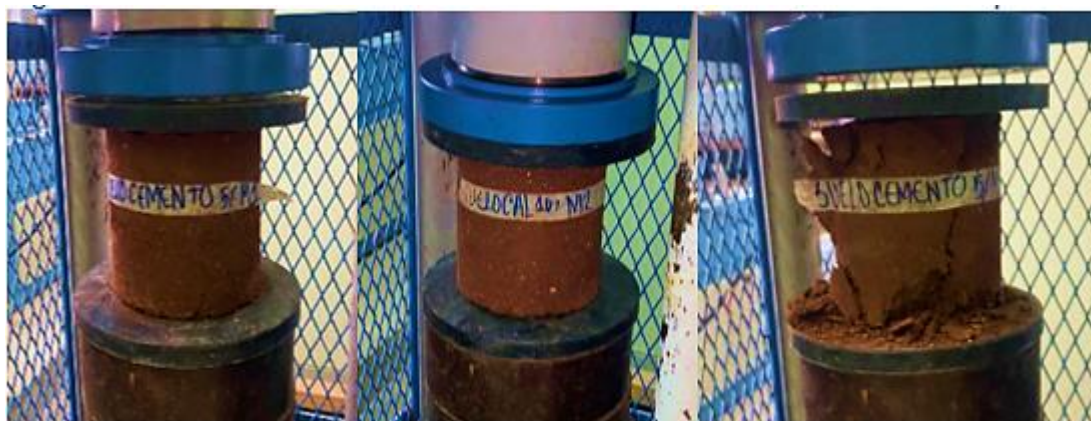
Figura 22 Probeta de suelo + cemento GU sometida a resistencia a la compresión.
