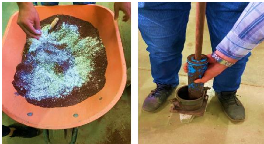
Figura 17 Mezcla de suelo + 10% Cal Hidratada y proceso de compactación.
