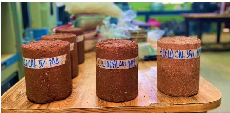
Figura 19 Probetas de suelo + 5, 10 y 15% Cal Hidratada
