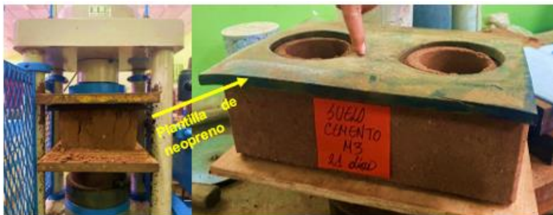
Figura 32 Plantilla de Neopreno utilizada en el ensayo de resistencia a la compresión.
