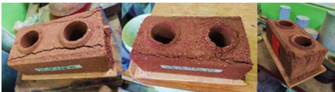
Figura 33 BTC sometidos a ensaye de resistencia a la compresión.
