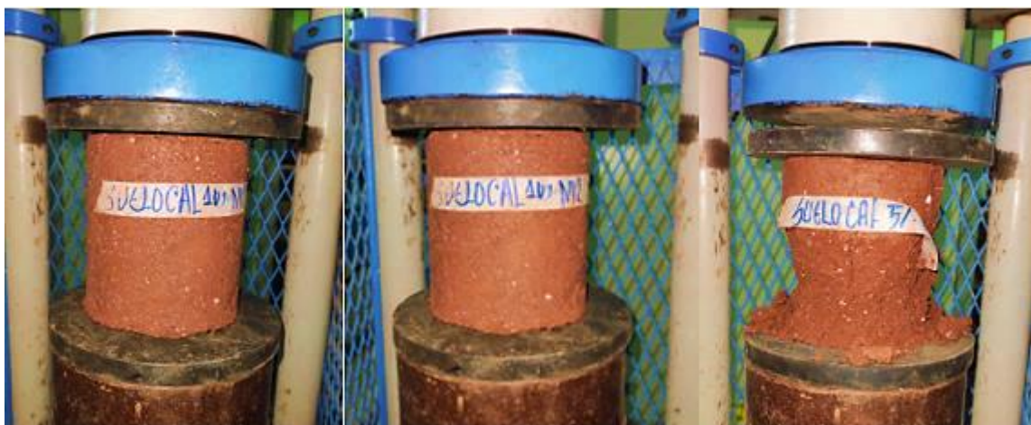
Figura 20 Probeta de suelo + Cal Hidratada sometida a resistencia a la compresión
