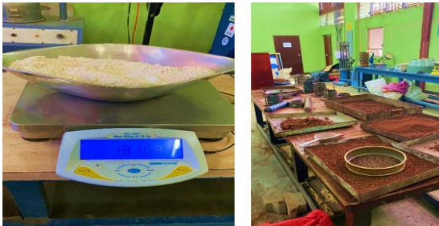
Figura 16 Preparación del suelo + el 10% de Cal Hidratada.
