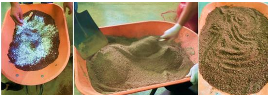
Figura 25 Mezcla en seco para fabricar BTC.
