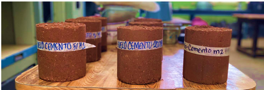
Figura 21 Probetas de suelo + 5, 10 y 15% cemento GU.
