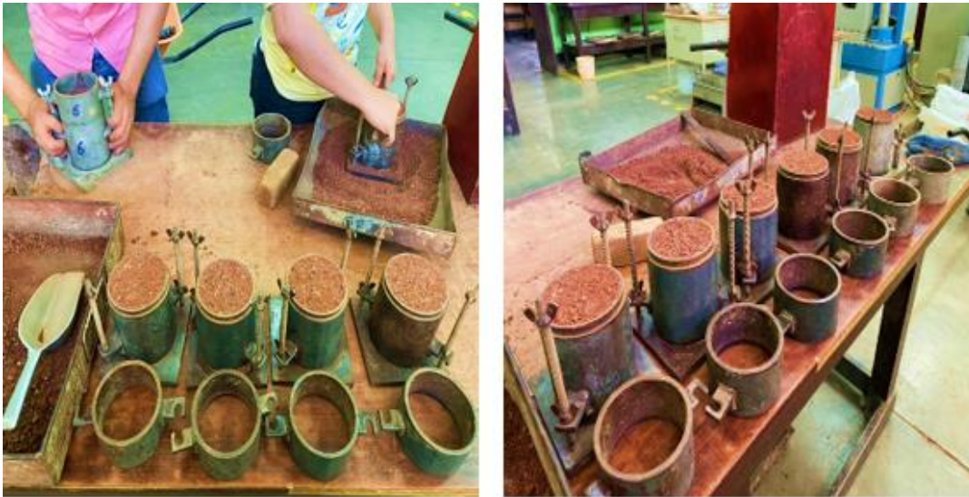
Figura 18 Proceso de enrasamiento y desmonte del collarín del molde.
